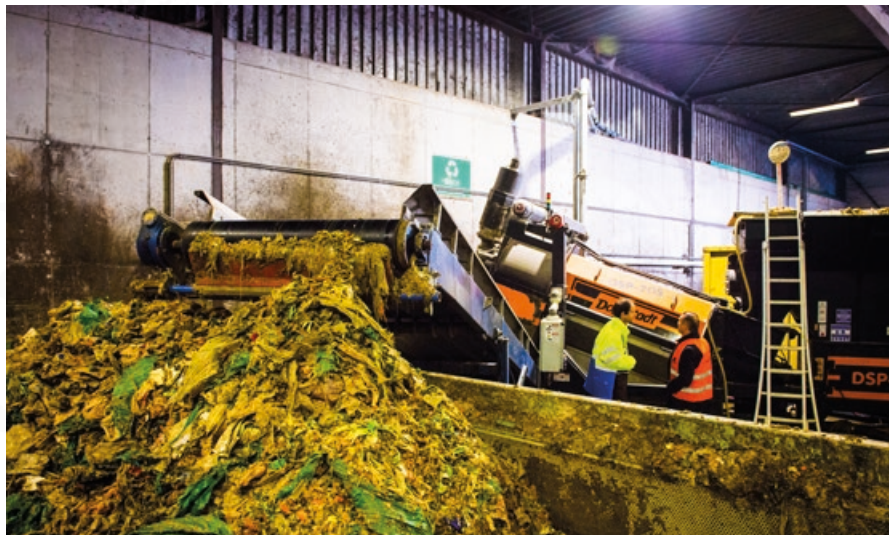
In een eerste stap worden voeding en verpakking gescheiden. Een machine scheurt en perst de verpakkingen.
